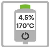
Wenn der Messwert stabil ist, wird der %TPM Wert permanent angezeigt (Signal-Lampe blinkt grün).
